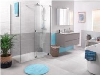
Verre 8 mm sur le coulissant et 6 mm sur le fixe avec traitement anti calcaire
