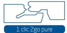
Toutes les collections **Lamina Floors** sont équipées du système **1cllic 2go pure** pour une pose simple et rapide avec un minimum d'outils et offrant une **excellente stabilité**.
